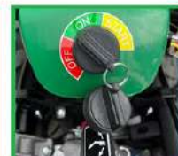
Elektro START motora sa akumulatorom
