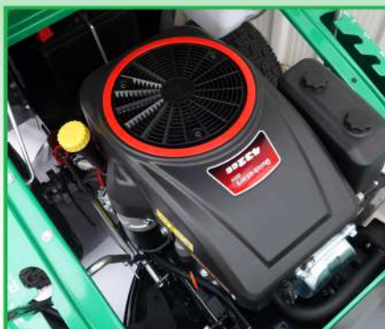
Snažan motor zapremine 432cm 3 , snage 15 KS
