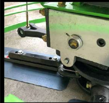
Kontrola nivoa i količine ulja u reduktoru
