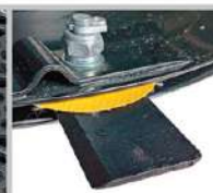
Rotor sa 4 pokretna noža U slučaju udara u prepreku noževi se uvlače u disk.
