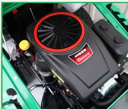
Snažan motor zapremine 432cm 3 , snage 15 KS
