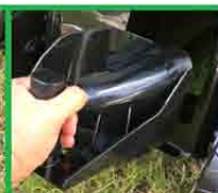
Zadnji umetak za siliranje trave
