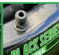
Konektor za pranje kućišta vodom
