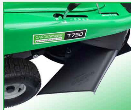
Izbacivanje pokošene trave na desnu stranu
