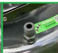
Priključak za pranje kućišta vodom
