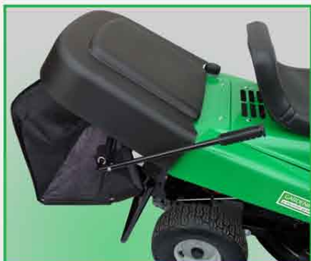
Izbacivanje trave u korpu zapremine 176L
