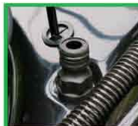
Priključak za pranje kućišta vodom
