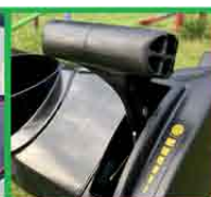
Podešavanje brzine košenja pomoću poluge
